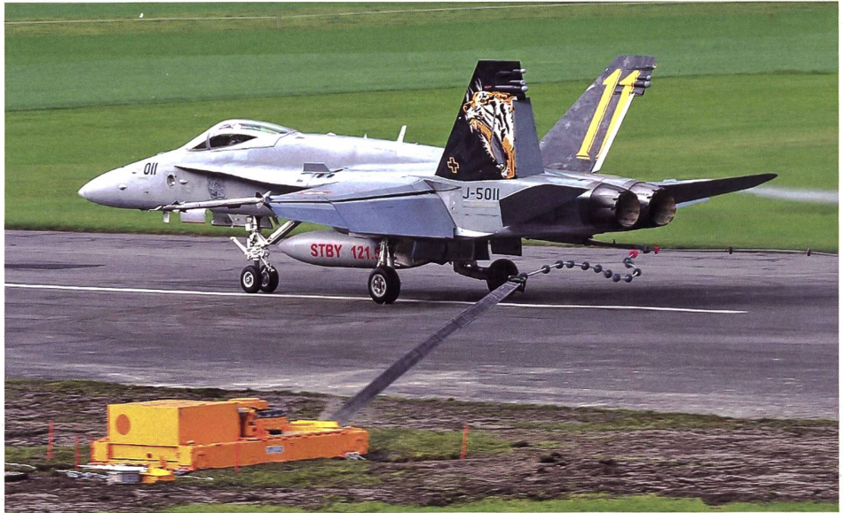
▲ Der F/A-18 greift mit dem Haken das Fangseil.
