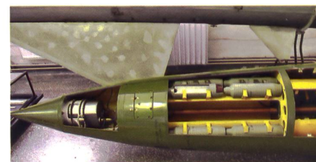
▲ Gefechtskopf des Raketensystems Tochka-U mit 50 Splitterbomblets. Bild: Autor einer Rüstungsausstellung
