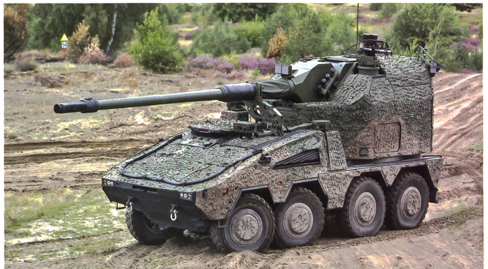
▼ RCH 155 von Krauss-Maffei Wegmann aus Deutschland mit einem Boxer-Fahrgestell.
