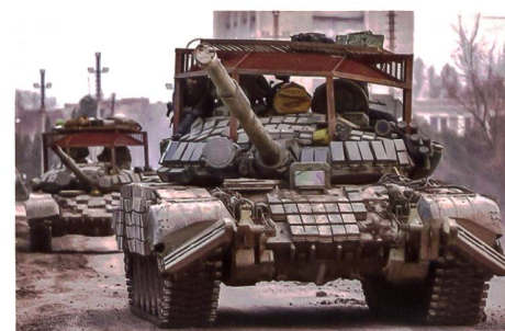
▼ Kpz T-72 mit improvisiertem Zusatzschutz gegen Beschuss von oben.
