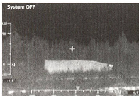
Adaptives Tarnsystem zur Täuschung im infraroten Spektrum. Bilder: BAE
