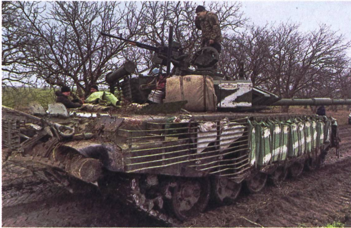
Der Kampfpanzer T-72B4 verfügt über seitliche Zusatzpanzerungen.
