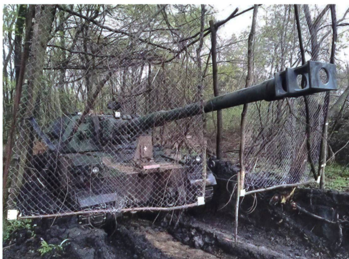
◀ Passiver und improvisierter Schutz, hier am Beispiel einer ukrainischen Panzerhaubitze vom Typ «Krab». Solche einfachen Schutzmassnahmen erweisen sich gegen Drohnen wie auch «Loitering Attack Munitions» als wirksam. Bild: via Twitter @NikGerassimov
