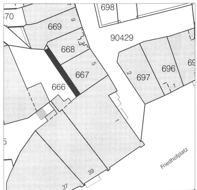
Abb. 3 Situationsplan Stalden 39, Schmiedengasse 1-7, schwarz gefärbt die 1685/86 neu erstellte Partie der mittelalterlichen Stadtmauer.
