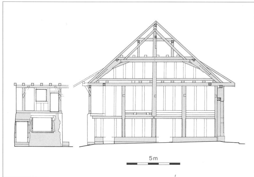
Abb. 6 Querschnitt durch die Scheune im Bereich des Tennis, Blick nach Westen, und Ansicht der Südfassade des baulich mehrfach veränderten Speicherteils von 1588 ff. Grau gerastert = Bauteile von 1588, weiss = jüngere Bauphasen.
