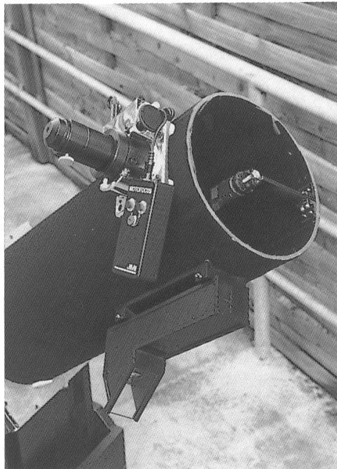
Abb. 2: Fangspiegelbefestigung, Okularauszug mit Handsteuerbox und Telrad-Sucher.
