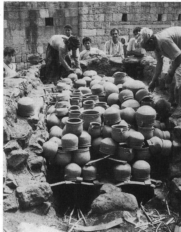
Abb. 11: Die ummauerte Brenngrube wird mit Gefäßen gefüllt. Zum Brennen wird die Grube anschliessend mit Wellblech abgedeckt. Töpferdorf Gahazah 1998.
