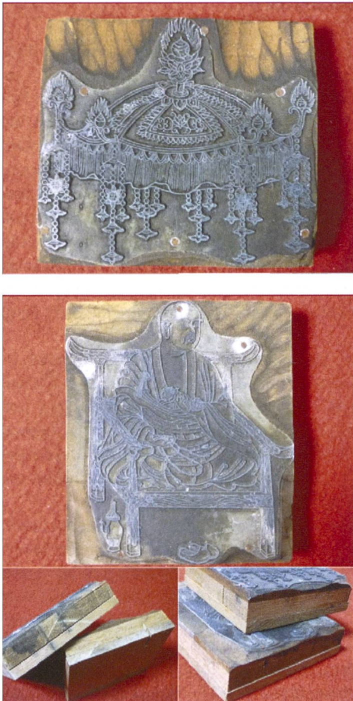
Abb. 7: Zwei Druckblöcke zur Herstellung von o-fuda , oben: Baldachin (8,4 × 7,4 cm), unten: Patriarchenbild (9,1 × 10,2 cm). Die Blöcke bestehen aus drei Schichten Holz, wobei die oberste aus dem traditionell für Holzschnitte verwendeten harten Kirschholz besteht. Auf diese Blöcke wurde die eigentliche Druckvorlage aus graviertem Kupfer genagelt. Die Blöcke konnten gemeinsam oder auch in anderen Kombinationen verwendet werden (Kadono Konzen bunko h170136953).
