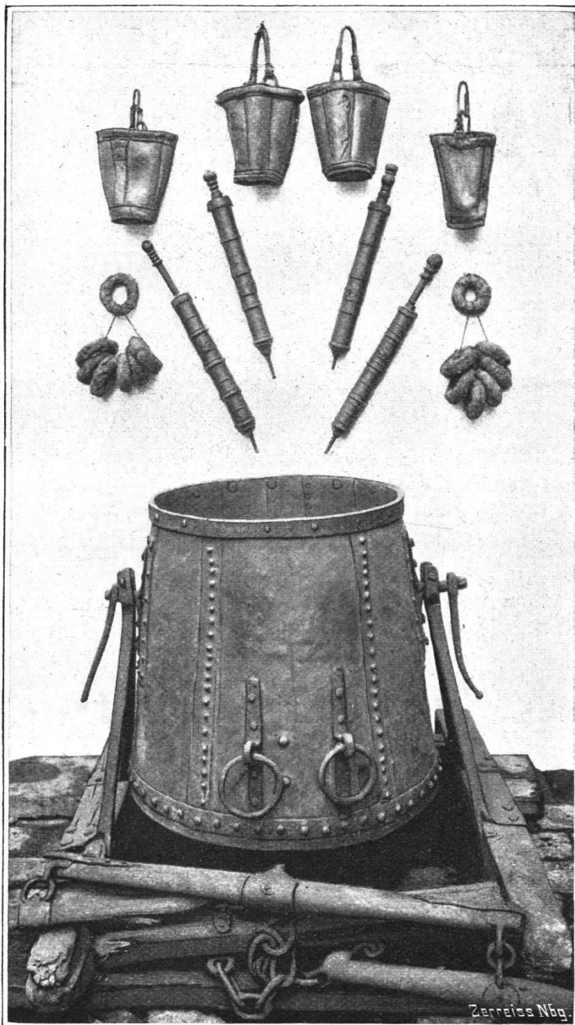
Fig. 2. Nürnberger Löscheräte: Kupferne Wasserkufe, 300 Liter fassend, auf Schleife; messingene Handfeuerspritzen 1499 und 1544; Ledereimer; Harzringe zur Beleuchtung des Brandplatzes.
