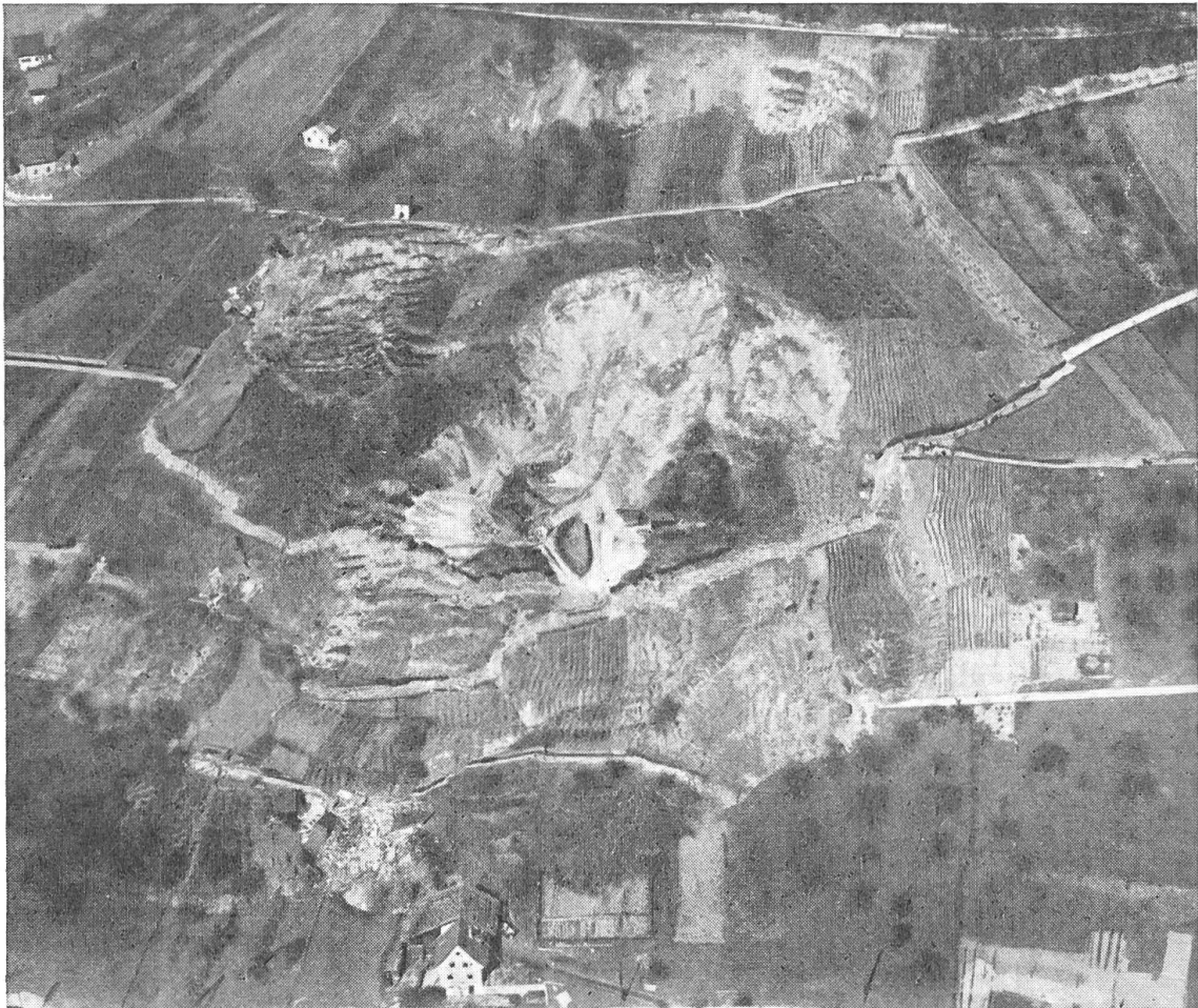
Bild 2. Flugaufnahme der Rutschung am Wartenberg, nach Abschluss der Bewegung, am 9. April 1952. Ansicht von Südwesten. Photo Hoffmann, Basel. Aus Schmassmann H., a. a. O. S. 66.
