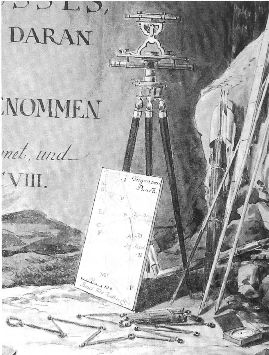
Abb. 9: Ein Detail aus der Kartusche von Abb. 8: Der Netzplan mit den 18 trigonometrisch bestimmten Punkten, welche das Gerippe des ganzen Planes bilden, darüber der Theodolit mit dem Horizontal- und dem Vertikalkreis, den Libellen und dem Fernrohr. Im Vordergrund die Messkette und die Bussole.
