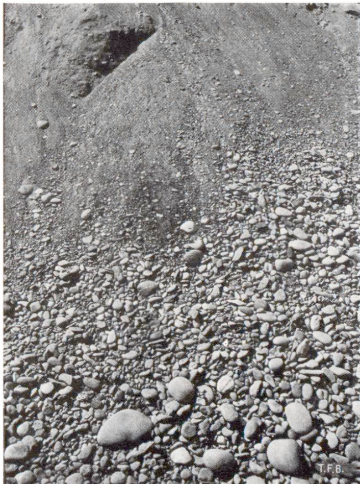
Fig. 1 Séparation dans un dépôt de ballast
