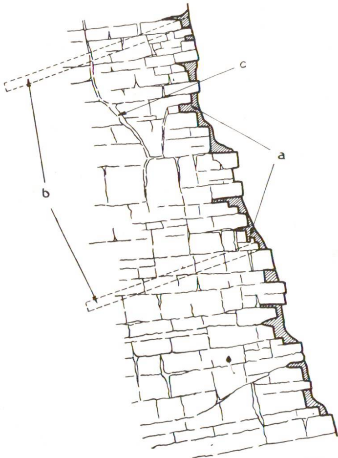
Fig. 3 Consolidation d'une raide paroi de rocher
