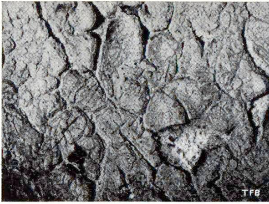
Fig. 4 Décomposition d'une peinture à l'huile appliquée sur une surface en ciment trop fraîche et non traitée
