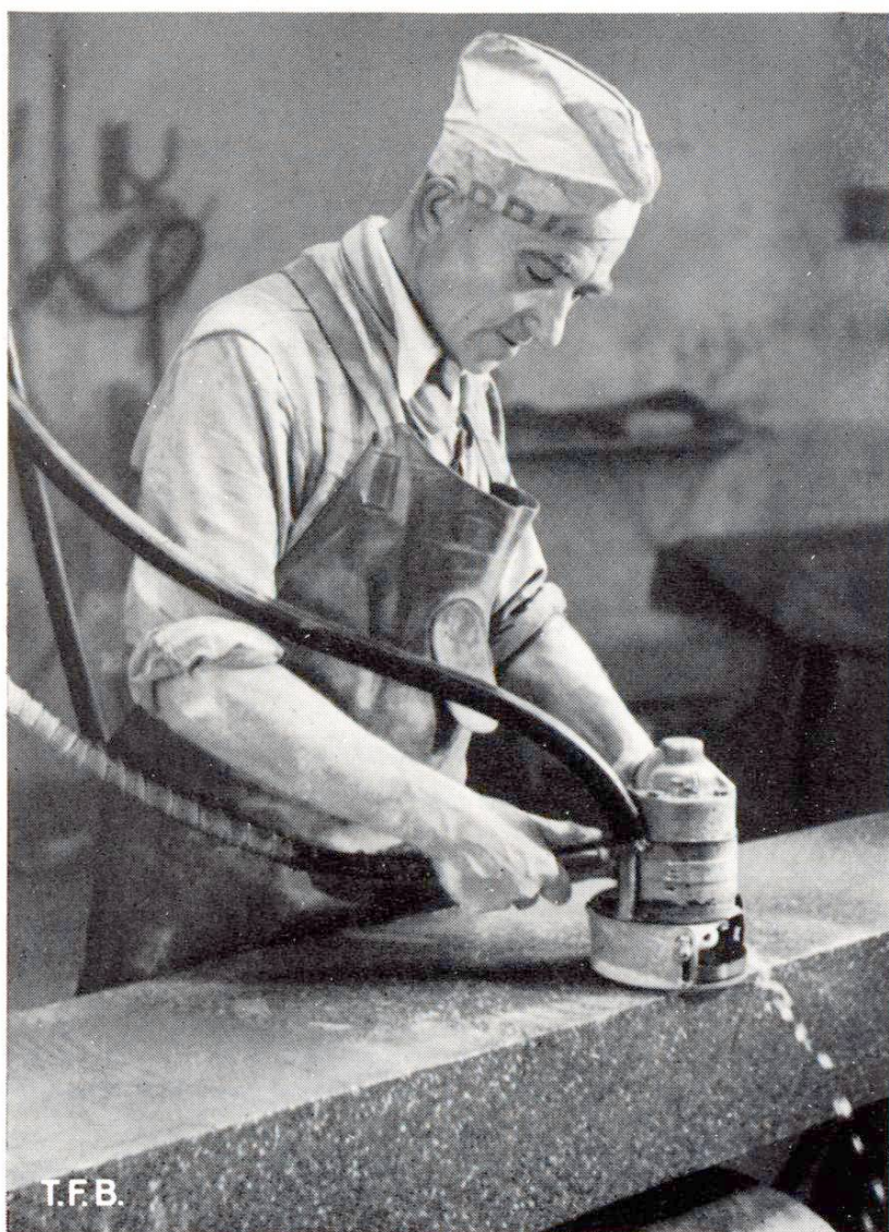
Fig. 2 Machine portable en service. Elle est actionnée et alimentée en eau par un flexible
