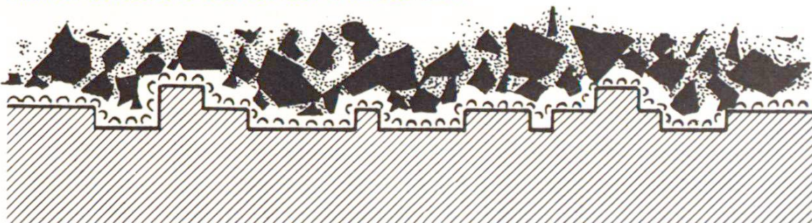
Fig. 5 Représentation schématique de l'action chimique diminuant l'adhérence. La surface du coffrage est imprégnée d'une substance empêchant la prise des grains de ciment. Le ciment en contact avec cette surface ne fait pas prise.
