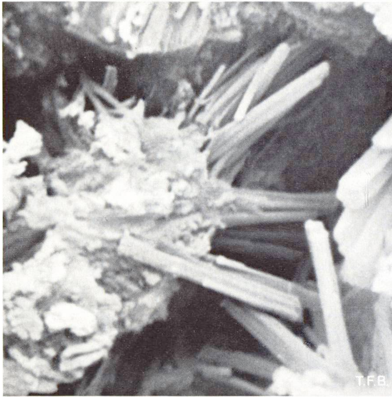
Fig. 3 Détail de la photo 2 au grossissement de 11 000. Au milieu à gauche, dans un pore, un grain de ciment, entouré d'une couche de points d'hydratation blancs sous formes cristallines. A partir de cette couche, les cristaux de Tobermorite croissent vers l'extérieur alors que d'autres aiguilles poussent à leur rencontre jusqu'à ce que le vide soit finalement complètement rempli de cet amas feutré.
