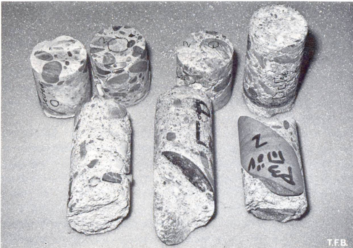
Fig. 2 Carottes prélevées dans l'ancien bâtiment, construit entre 1910 et 1930. Remarquez la granulométrie des graviers utilisés alors.
