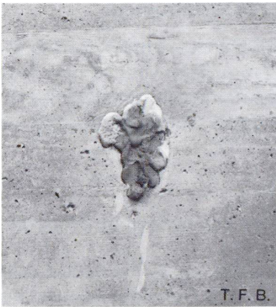
Fig. 9 La pâte est à moitié desséchée.
