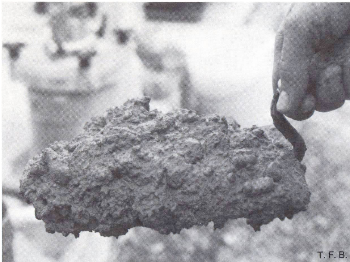
Fig. 2 Béton légèrement fluide, riche en mortier qui ne montre aucune tendance au démélange.
