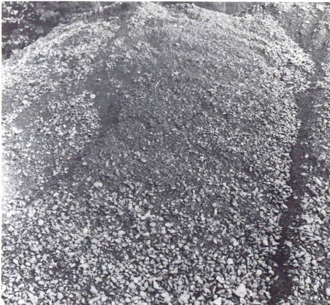
Fig. 3 Ségrégation des grains dans un dépôt en tas.
