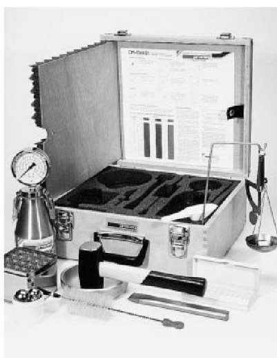
Appareil CM pour déterminer rapidement la teneur en eau des échantillons de béton.
