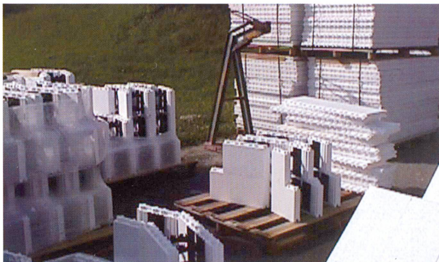
Les différents éléments du système ABC se composent de mousse de polystyrène rigide légère.
