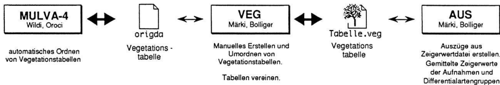
Fig. 1. Das Zusammenspiel der Programme. Das Programm VEG eignet sich zur Eingabe und manuellen Auswertung von Vegetationstabellen. Die Tabelle kann zur automatisierten Auswertung in das leistungsfähige Programm MULVA-4 eingelesen werden, nachdem sie als origda-Datei gespeichert wurde. Zur geordneten Tabelle berechnet das Programm AUS die gemittelten Zeigerwerte.
