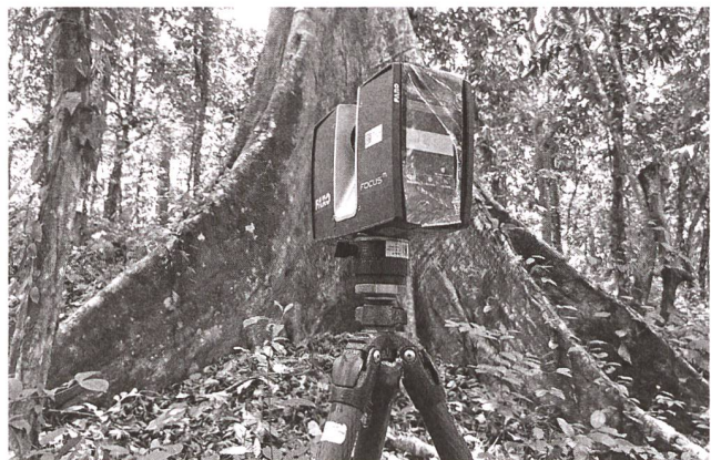
Abb. 1: Laser Scanning im Rahmen von SUSTAINFORESTS mit dem FARO M70 Terrestrial Laser Scanner (TLS) in einem Regenwald mit Lianen und invasiven Spezies. (Bildnachweis: Chinwe Ifejika Speranza / Samuel Hepner)
