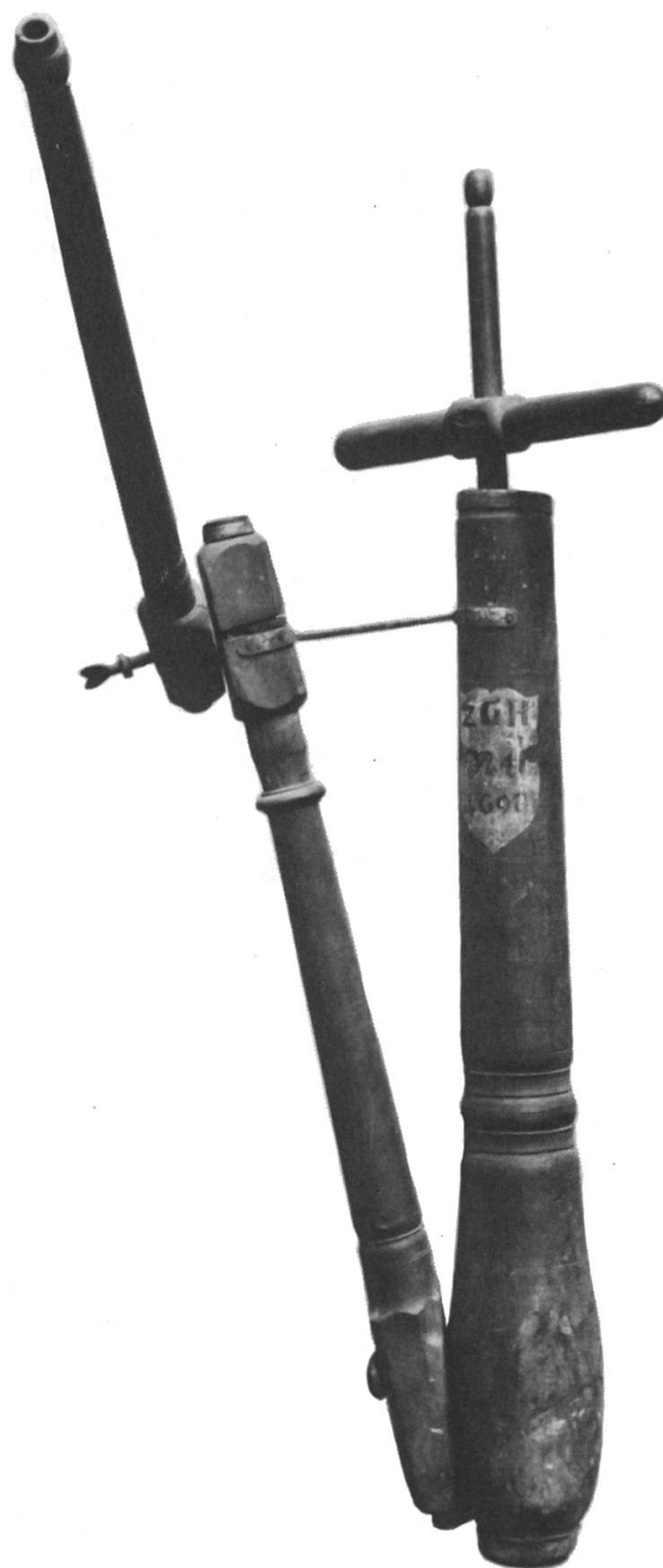
9. Alle drei Spritzenrohre dieses Sprizentyps aus dem Jahre 1692 sind durch Gelenkdurchflüsse miteinander verbunden. Durch stetes Betätigen des Kolbens wurde ein stossweiser Wasserstrahl verursacht. Das Bodenstück stand für den Gebrauch der Spritze in einem wassergefüllten Zuber, der mit Hilfe der Eimerkette Wassernachschub erhielt. Schweiz. Feuerwehrmuseum Basel.
