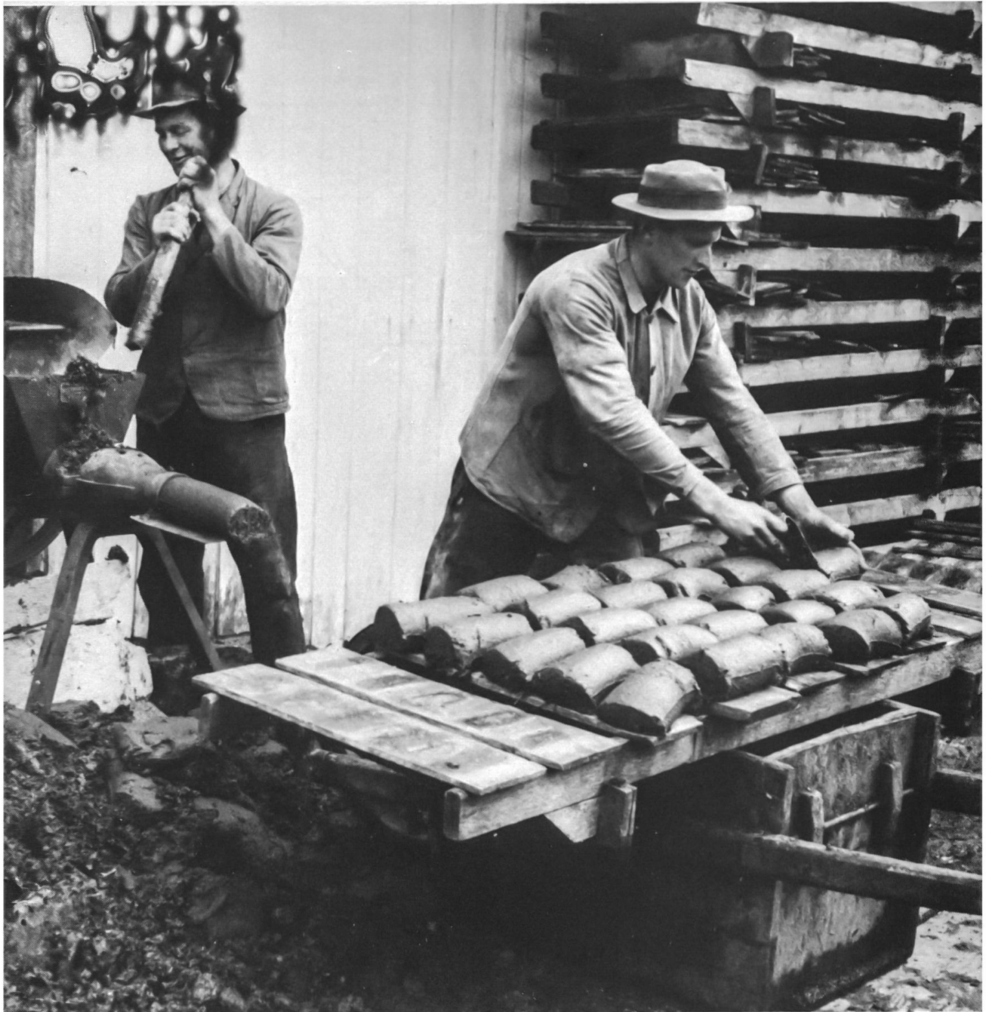
92 Nach dem Brennen im Frühling wurde der Trester in eine Kiste fest eingestampft, dann wurden mit einem Hohlstößel zylindrische Stücke herausgestochen, die sogenannten Träbstöckli. Bei der mechanischen Herstellungsweise wurde, wie abgebildet, der Trester mit einer Hackmaschine zu Würsten gepresst, die geschnitten wurden und so ebenfalls zylindrische Stöckli ergaben. Die Träbstöckli wurden nach dem Formen auf Gestellen zum Trocknen aufgeschichtet und im nächsten Winter in Zimmeröfen verbrannt. Häufiger war, dass man im nächsten Jahr damit die Schnapsbrennerei wieder anheizte. Das Bild zeigt die Herstellung von Träbstöckli auf dem Ennerberg im Frühling 1939. Links Josef Barmettler, rechts Alois Barmettler.
