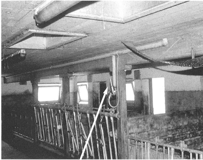
Abbildung 5: Kaskadenimpaktor auf Kopfhöhe im Stall. (Foto R. Cathomas, 2002)
