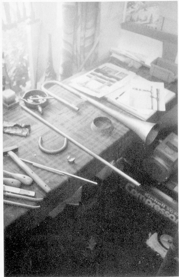
Abb. 21 und 22: Die Posaune nimmt langsam Gestalt an. Auf dem Werk Tisch (rechts) liegt der fertig ausgehämmt Schallbecher mit aufgestecktem Bogen und Seitenteil, daneben der Blechring für den Kranz, ein fertiges Zugrohr und der Zugbogen.
