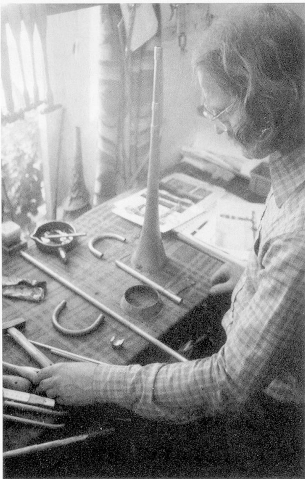
Abb. 21 und 22: Die Posaune nimmt langsam Gestalt an. Auf dem Werk Tisch (rechts) liegt der fertig ausgehämmt Schallbecher mit aufgestecktem Bogen und Seitenteil, daneben der Blechring für den Kranz, ein fertiges Zugrohr und der Zugbogen.
