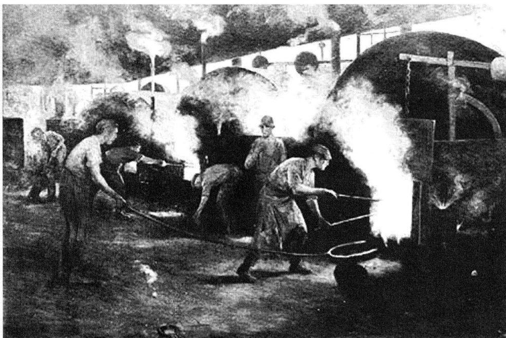
Der Puddler zieht einen Klumpen Schweisseisen aus dem Puddlingofen. Sein Gehilfe wird ihn mit dem Transportwagen zum Auswalzen bringen. Wales, ca. 1860.
