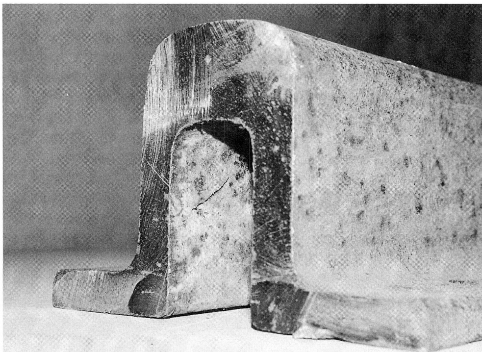
Offen sichtbare schlechte Verschweissung.
