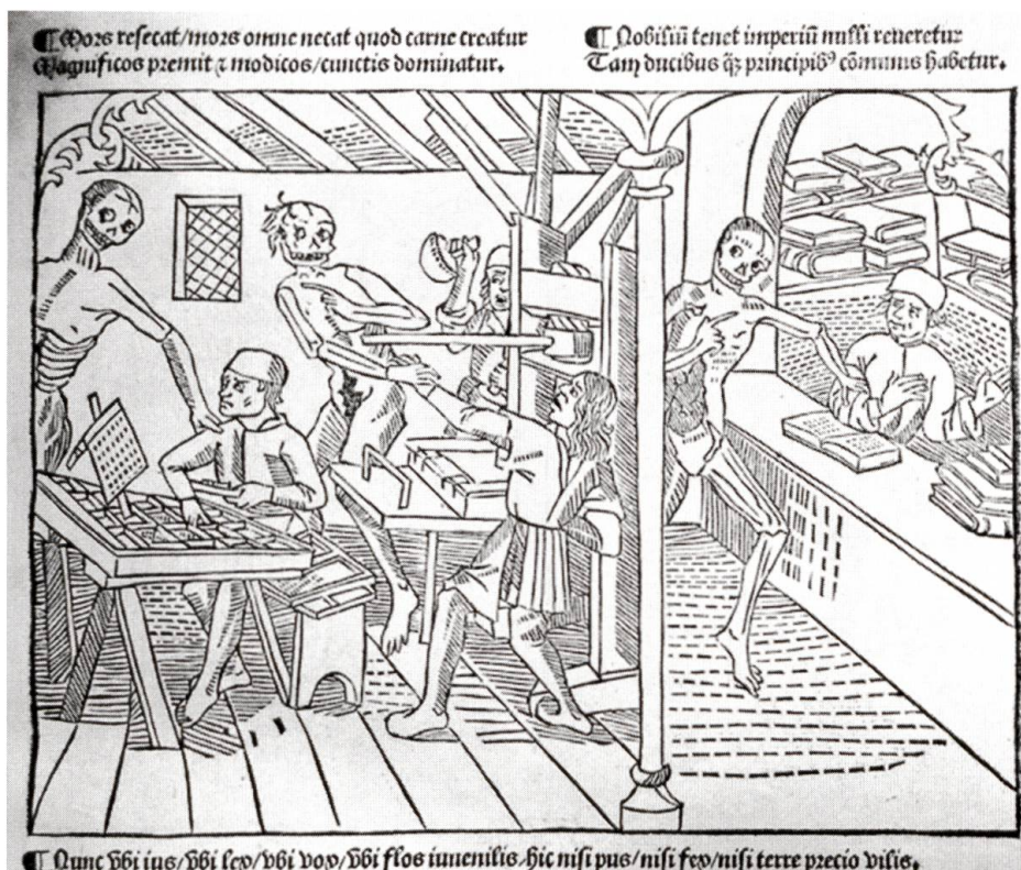
Abb. 7: Lyoner Totentanz (Ausschnitt; Matthias Huss, 1499) mit Setzerei und Druckerpresse aus Holz; rechts davon ist die Buchhandlung sichtbar. Die Druckerpresse ist nicht allzu wuchtig, aber in der Holzdecke verstrebt. Die Spindel läuft falsch, eventuell eine Folge der nicht bedachten Seitenverkehrung beim Druck des Holzstockes?
