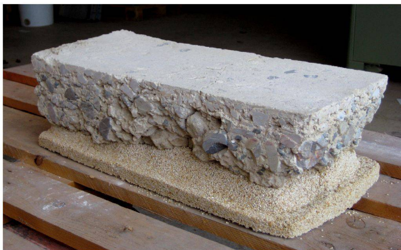
Fig. 14 Sol en terrazzo, prêt à être intégré dans la collection d'étude des matériaux de construction
