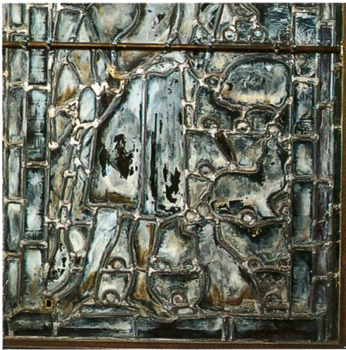
Abb. 7 n II, 3a; Wetterstein auf der ganzen Glasfläche.
