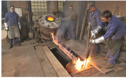
Die Glockenspeise wird in das Gussloch geleitet.
