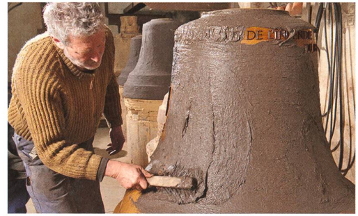
Für die Aussenhülle wird die «falsche Glocke» mit Lehm bestrichen.
