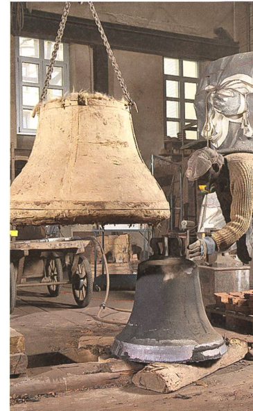
Unter der Gussform kommt die fertige Glocke zum Vorschein.
