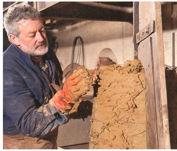
Der Kegel für die Gussform wird aus Lehm geschichtet.
