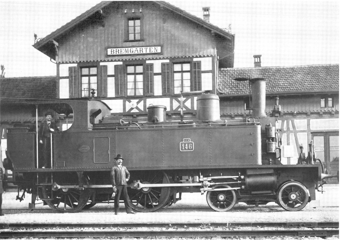
SCB Dampflokomoitive Eb 2/4 146. Fabrike-Nr. 4504. Baujahr: 1893. Austrangiert: 1929. Gebaut von SLM Winter- 66 thur. Gewicht: 32 t. Achsstand: 7 m. Foto: Lüthy, Bremgarten
