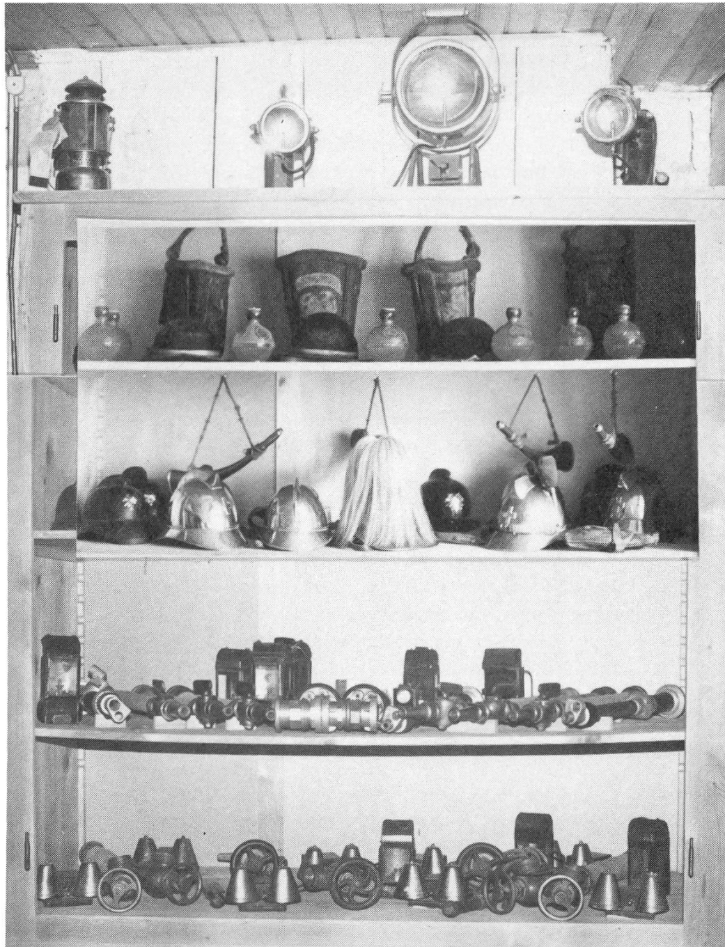
Von oben nach unten: Scheinwerfer (Gas); Wassereimer 1784, Helme 1700, Löschgranaten 1915; Helme, Feuerhörner; Kerzenlaternen, Stahlrohre; Kerzenlaternen, Telefonglocken, Standrohre zu Unterflur-Hydranten Foto: Th. Hauser
