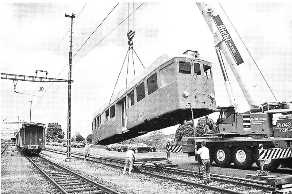
Der Kasten des Triebwagens BDe 4/4 Nr. 11 wird in Stein-Säckingen vom Lastwagen auf Roll-schemel verladen. (Foto D. Häusermann)
