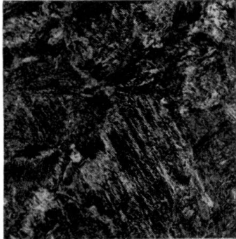
Température: — 10° C. Martensite avec traces de troostite trempée.
