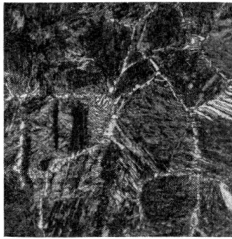
Non préchauffé, formation de martensite.
