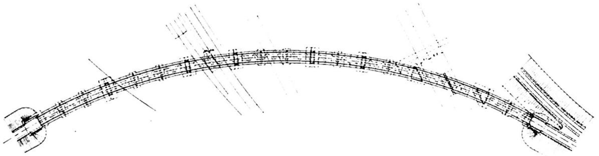
Abb. 14. Ansicht einer Eisenbahnbrücke mit konstantem Krümmungshalbmesser.
