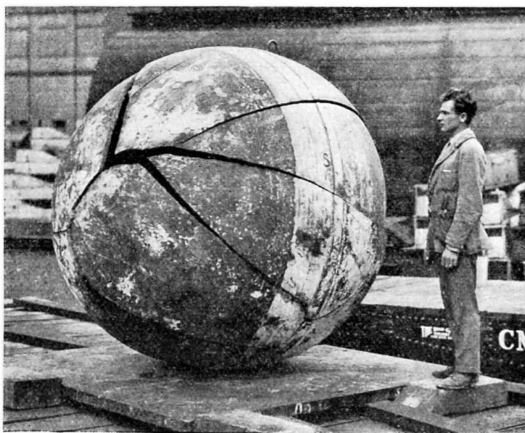
Fig. 3. Eclatement d'une sphère par pression hydraulique; cet essai réalisé à la Smith Corporation (U. S. A.) montre un cas de rupture sans déformation apparente.
