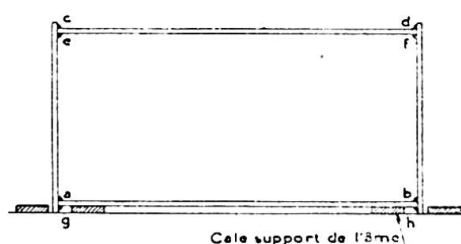
Fig. 8. Schéma du processus de soudure en atelier d'un tronçon d'arc du pont de Neuilly.
