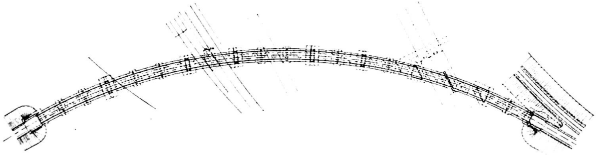
Abb. 14. Ansicht einer Eisenbahnbrücke mit konstantem Krümmungshalbmesser.
