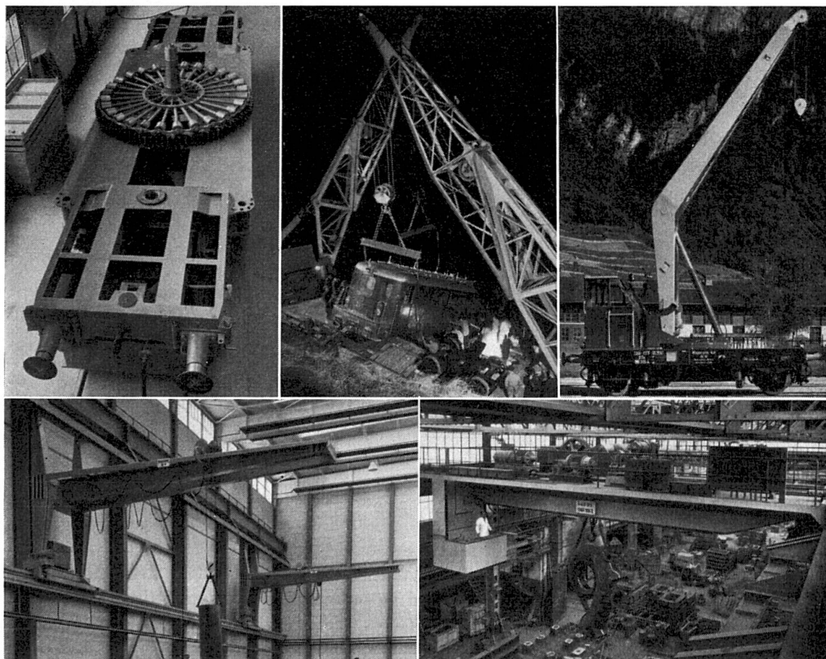
Fig. 5. De gauche à droite et de haut en bas: châssis d'un wagon-grue de 25 t, wagons-grues de 25 t au travail, wagon-grue de 4 t, grues- consoles et pont roulant d'atelier.
