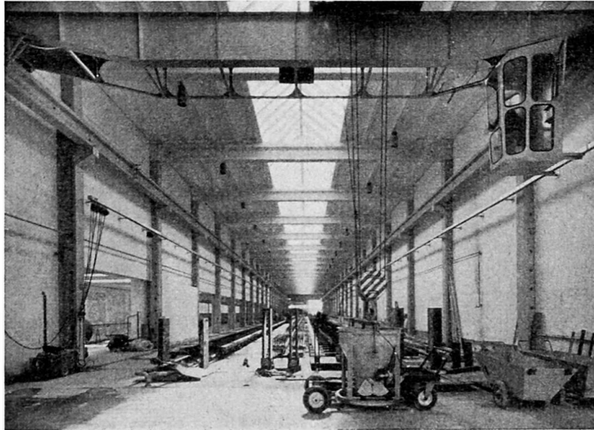
Abb. 3 - Spannbetonwerk in Avenches, mit ca. 80 m langen, permanent installierten Spannpieten. Ingenieur: M. R. Ros, Zürich. Unternehmer: Stahlton-Prébéton SA, Bern.
