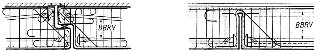
Fig. 8. Gelenk für Gerberträger. Links nach der üblichen Ausbildung, rechts nach Vorschlag von Prof. H. Hauri, ETH.
