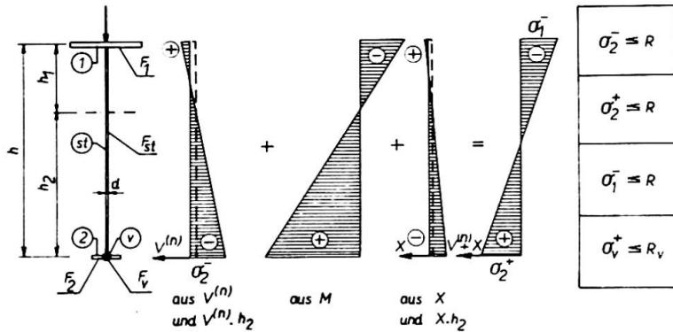
Bild 1. Spannungsbild bei einstufiger Vorspannung.  $V^{(n)}$  - Normwert der Vorspannkraft;  $M$  - maximales Berechnungsbiegemoment aus der Belastung am Träger ohne Zugband;  $X$  - statisch unbestimmte Komponente der Zugbandkraft aus der Berechnungsbelastung;  $R$  - Berechnungsbeanspruchung /Index  $v$  ist für das Zugbandmaterial/
