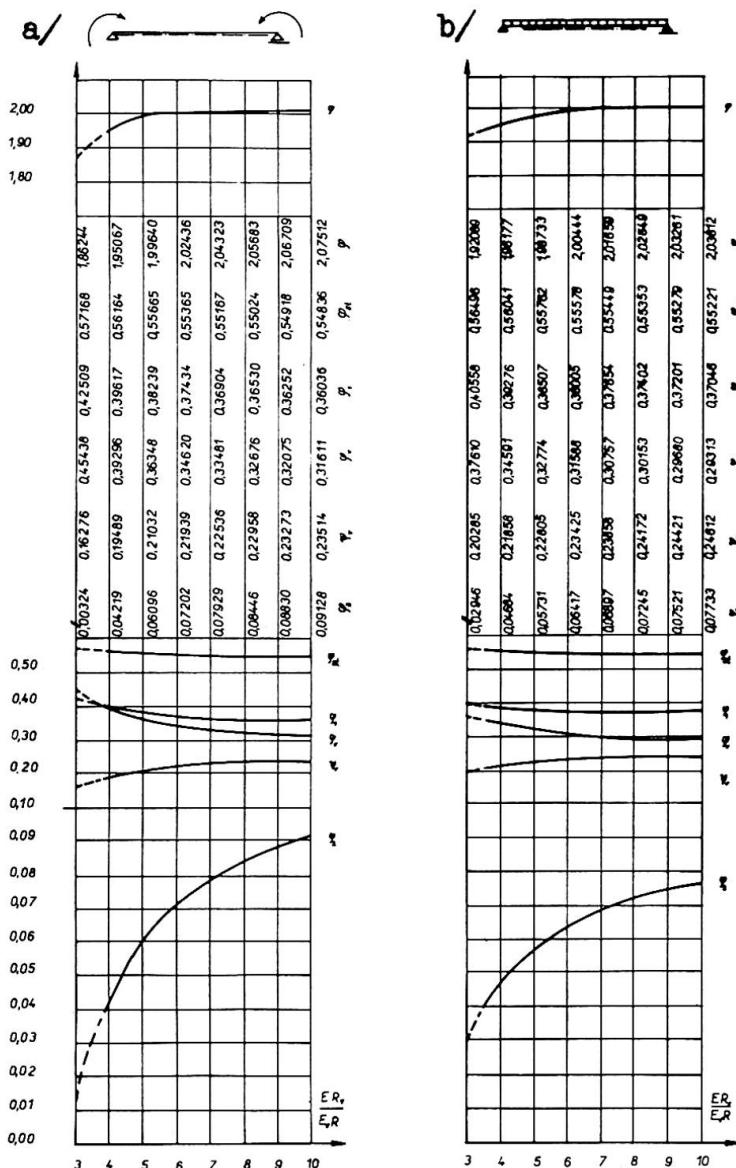
Bild 2. Bemessungsbeiwerte für den Entwurf des vorgespannten Vollwandträgers:
