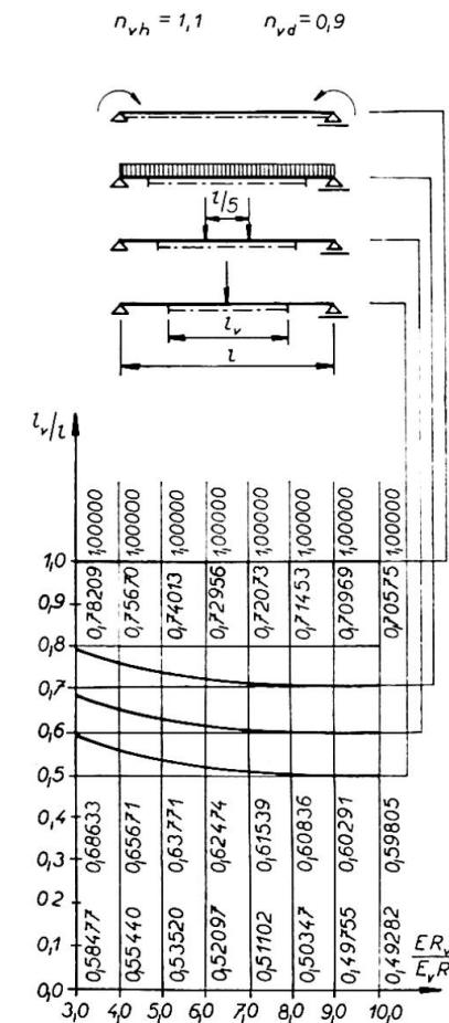
Bild 3. Verhältnislängen  $l_v/l$ ; die Zahlenwerte entsprechen den zugehörigen Belastungen in der Reihenfolge wie die Belastung angeführt ist
