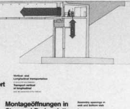
Montageöffnungen in Steg und Bodenplatte
