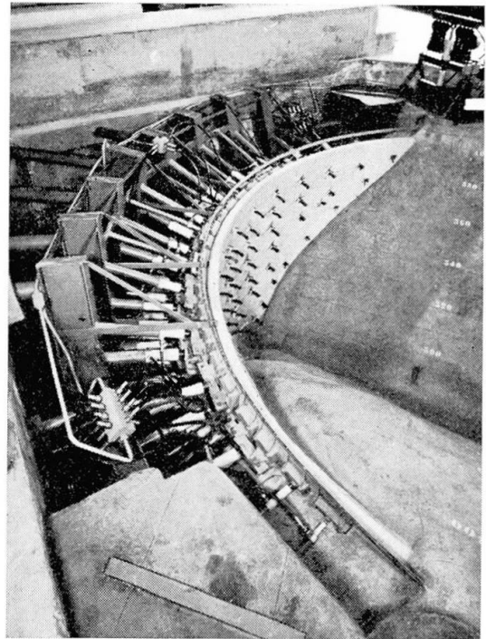
Fig. 14. Modèle du barrage de «Grancarevo»: appareillage type pour la charge hydrostatique (échelle 1 : 80).
