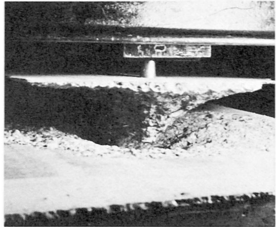
Bild 8 Bruchbild bei Betonausbruch
